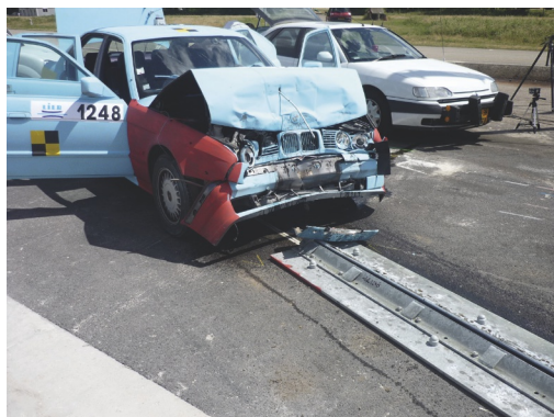
Figuur 38 Dankzij de kreukelzone is de botsafstand groter en de kracht kleiner.
