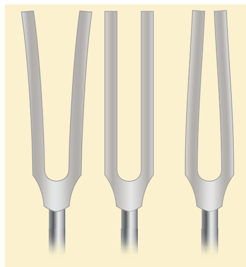
Figuur 5 Momentopnamen van een trillende stemvork (overdreven weergegeven). De middelste tekening is de evenwichtsstand.
