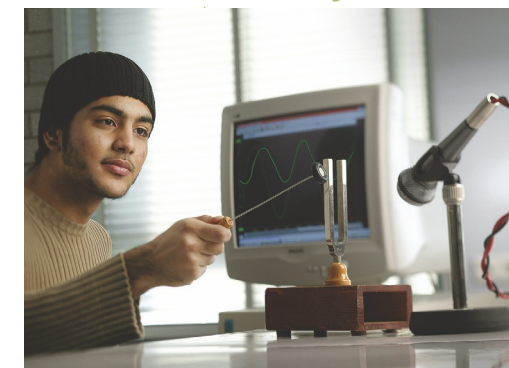
Figuur 6 Een oscillogram maken van een stemvork op een klankkast
