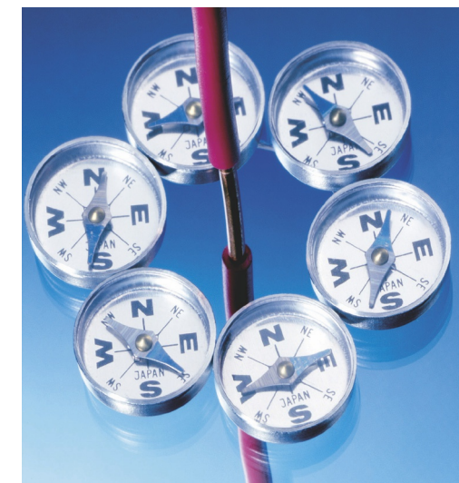
Figuur 14 Stroomdraad loodrecht op een doorzichtig blad met kompasjes
